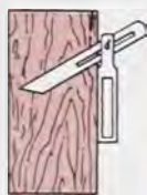
9. ábra Szögmérésre alkalmas eszköz az ún. sáskaláb (0-180°)
